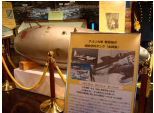
写真2 アメリカ軍戦闘機の補助燃料タンク（金属製）（宇和民具館所蔵）
